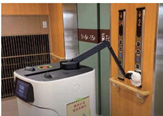
搬送ロボット「GAEMI」は、AI制御のロボットアームでエレベーターに乗ることができる
